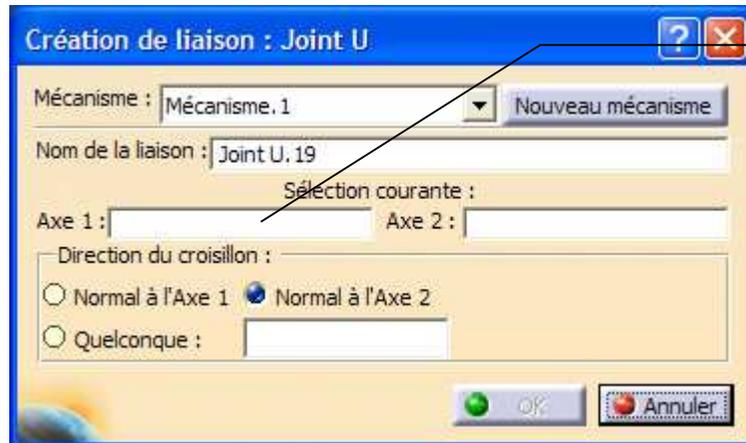
Définir les deux axes sur la platine et sur le corps de vérin
