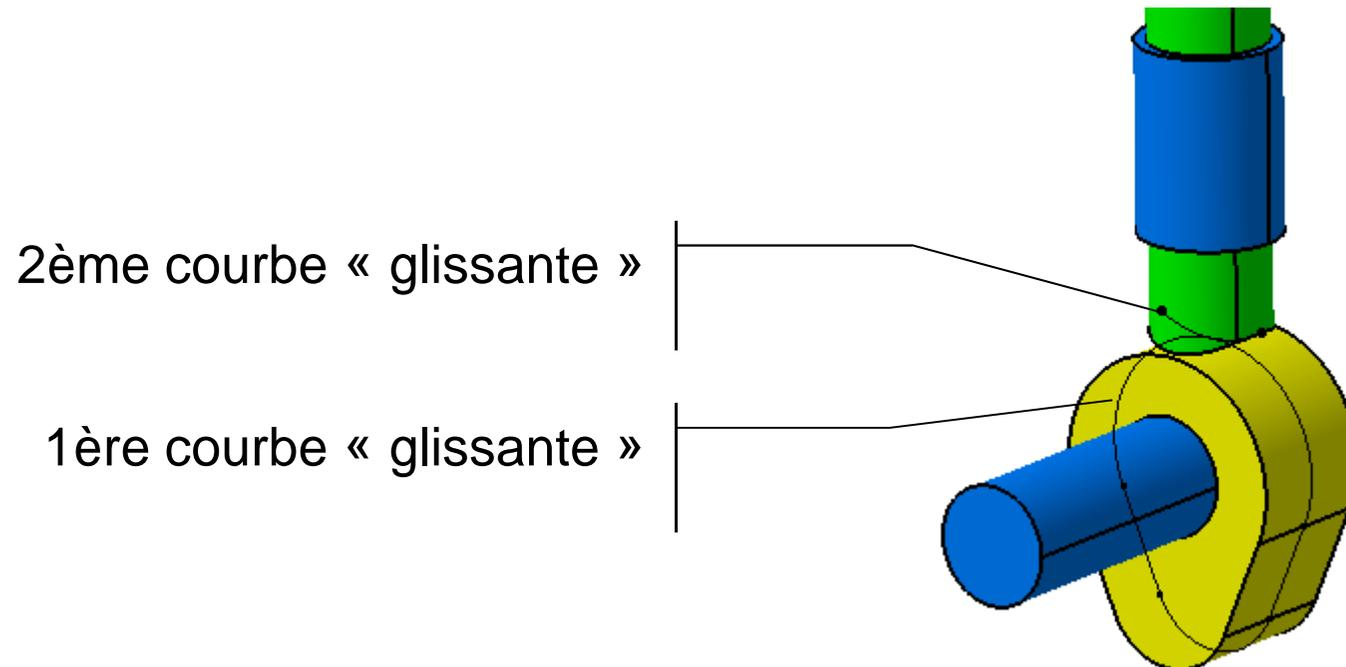
**Modéliser le sous-ensemble représenté ci-dessus avec une commande sur l'arbre à came**
