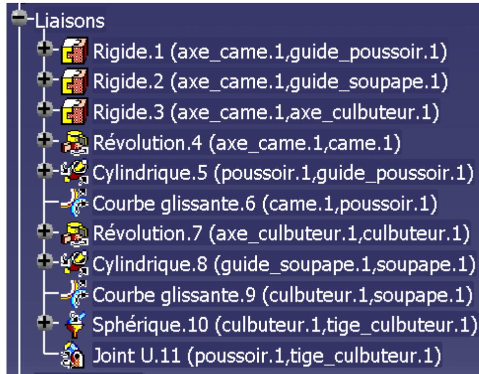
**Modéliser l'ensemble du système en utilisant les courbes et points pré-définis**
