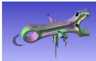
La registration est faite sous les logiciels dédiés à un matériel ou sous des logiciels spécialisés type Rapidform
