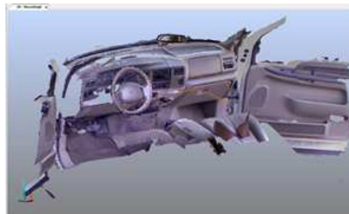
Numérisation 3D avec Kinect et SCENE
