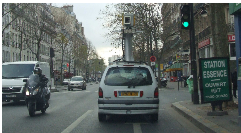
Figure 4-5 : Trimble GX avec accéléromètre sur LARA-3D.
