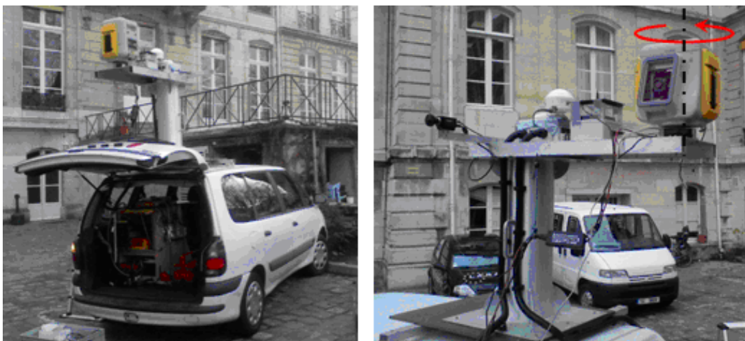
Figure 4-8 : Trimble GX sur LARA-3D
