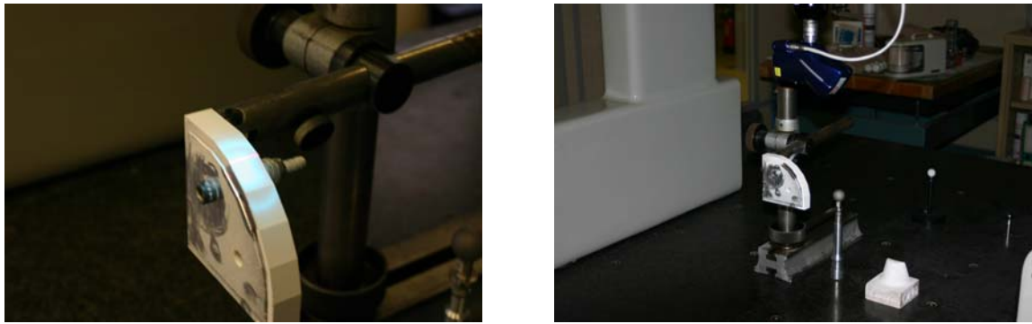
Figure 10 : Artefact de variation de l'angle de numérisation
