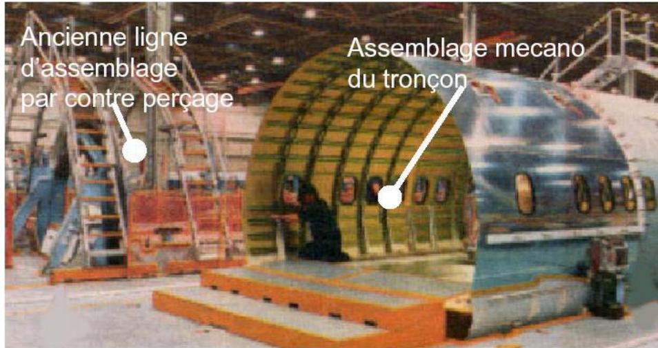
Simulation d'assemblage "mécano" de structures airbus
